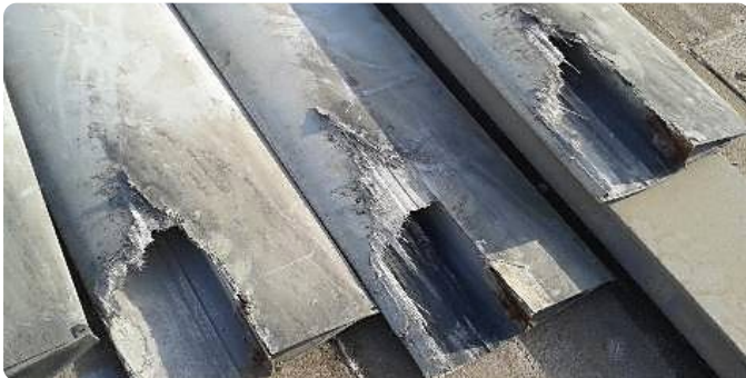
FRP fan blades before repair
